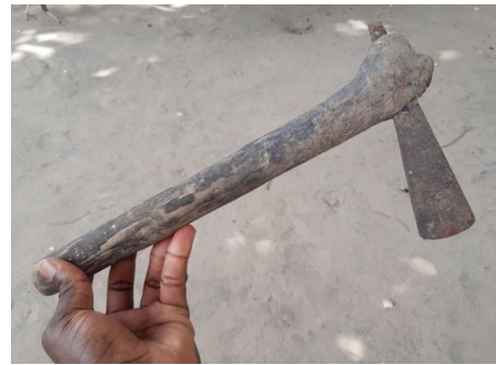
Figure 13 : Hache portable spéciale pour la récolte d'huîtres sur les racines de mangroves.
