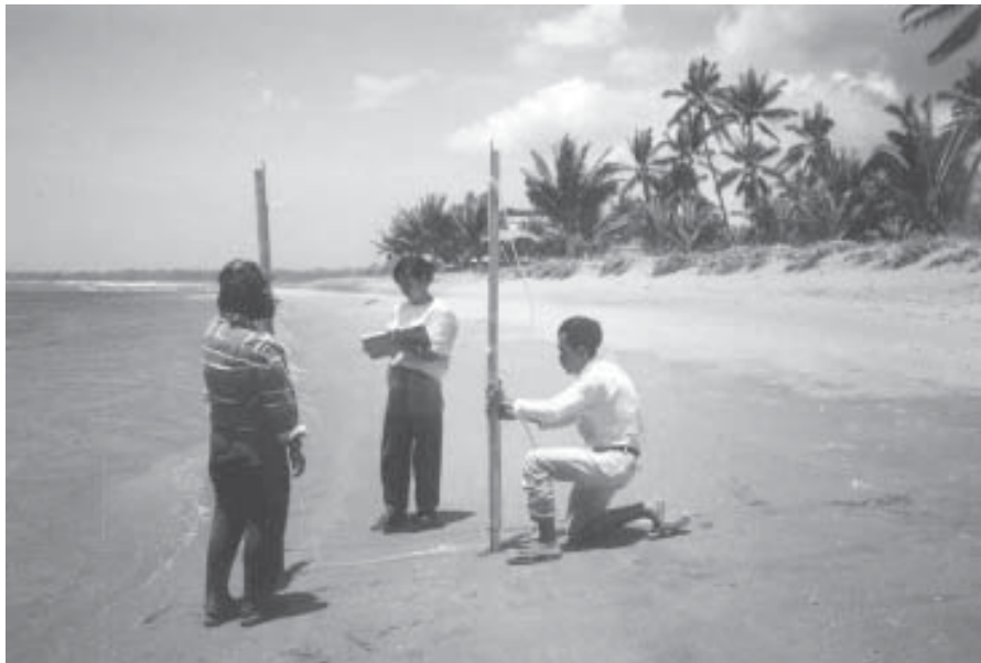
Gambar 14. Pengukuran profil pantai untuk mengetahui perubahan garis pantai. (Foto: Proyek Pesisir Sulut)
