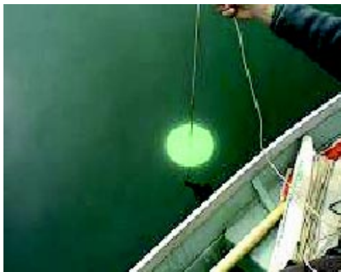
Figura 9. Forma de medir turbidez del agua usando un disco Secchi
