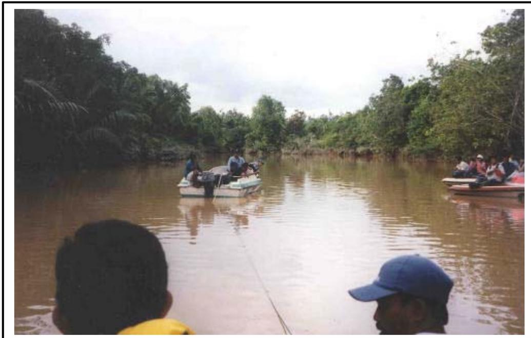
**Tim survei kelompok erosi dan sedimentasi menelusuri outlet-outlet (patusan) di DAS Teluk Balikpapan dan pengambilan sampel sedimen melayang dan pengukuran laju limpasan air sungai**
