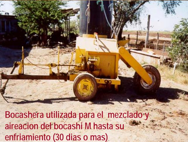
Bocashera utilizada para el mezclado y aireación del bocashi M hasta su enfriamiento (30 días o mas)
